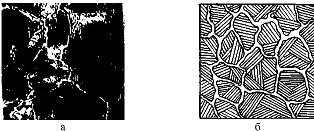
а – микроструктура: перлит+цементит II ; б – схема микроструктуры
